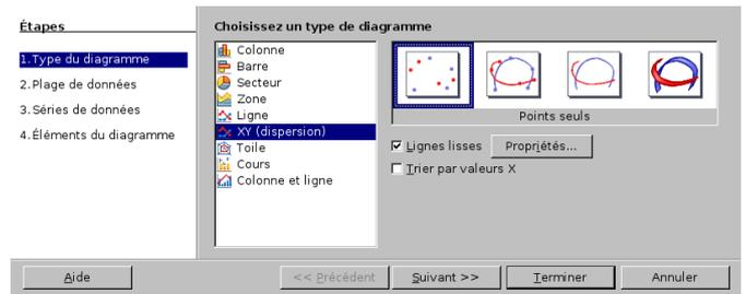
5. Sélectionner le type de courbe de jointure 'Spline cubique' (optionnel) :
