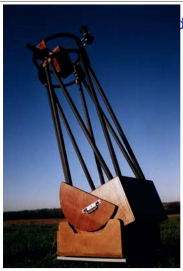
*Télescope Dobson de 45 cm de diamètre.*
