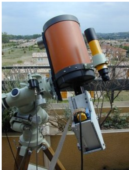
FIG. 4 – Un spectroscopie prêt à l'emploi.
